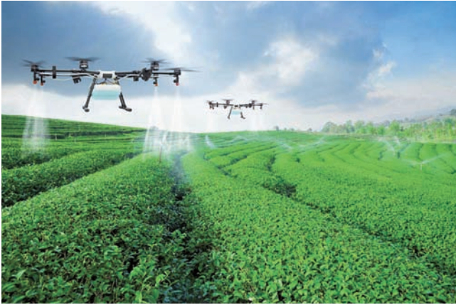
Obr. 12 Autonómne drony pri aplikácii postreku [9]
