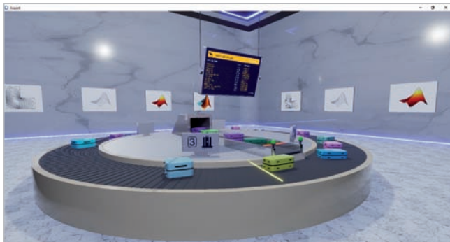
Virtuálny model dopravníka umožňuje testovanie riadiacich algoritmov dávno predtým, ako je zariadenie nainštalované na mieste.
