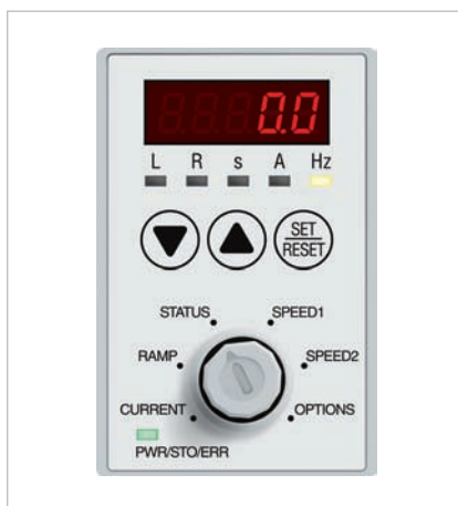
Obr. 2 Intuitívne rozhranie obsluhy nového hybridného motorového spúšťača
