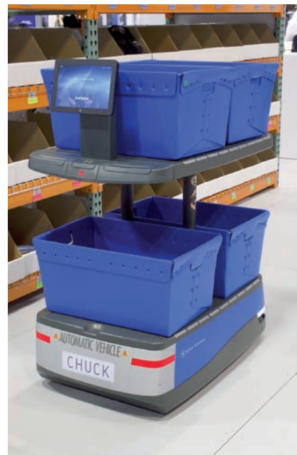
Obr. 2 Na mobilnom robote Chuck sú svetlá, ktoré operátora navedú na presné uloženie položky alebo jej vybratie.
